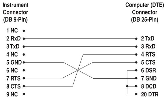
*Figure 14 RS-232 wiring*
